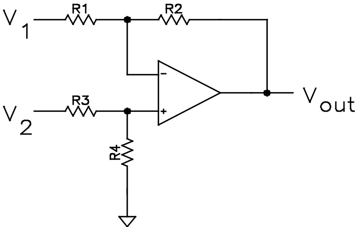
$$V_{out} = \left( \frac{R_1 + R_2}{R_3 + R_4} \right) \frac{R_4}{R_1} V_2 - \frac{R_2}{R_1} V_1$$
